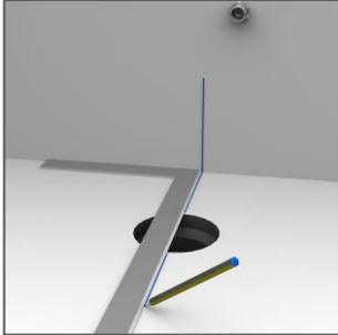
1 – Traçar uma perpendicular à parede com passagem pelo centro do esgoto.
