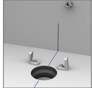
3 – Instalar o kit de fixação sanita.
