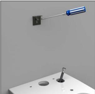
7 – Instalar chapa fixação reservatório com o parafuso a ficar ao meio da ranhura.
