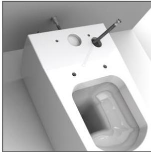
5 – Instalar a sanita aplicando o tubo de descarga no esgoto. A bicha da água fica já de forma a poder-se ligar ao reservatório.
