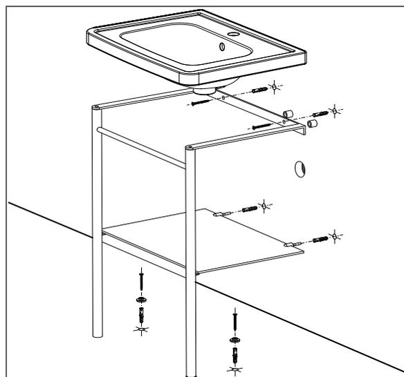
**Fig. 2** – Furar a parede e o chão nos pontos encontrados. Colocar as buchas. Aparafusar os tacos dos pés do móvel no chão. Enfiar as pernas do móvel nos tacos aparafusados ao chão. Aparafusar o móvel à parede.
