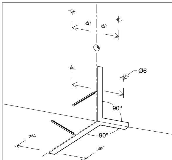
**Fig. 1** – Traçar na parede uma perpendicular ao chão, a passar pelo centro do furo do esgoto. Traçar no chão uma perpendicular à parede, conforme a fig.1. Localizar os pontos a furar conforme as medidas na fig. 3.
